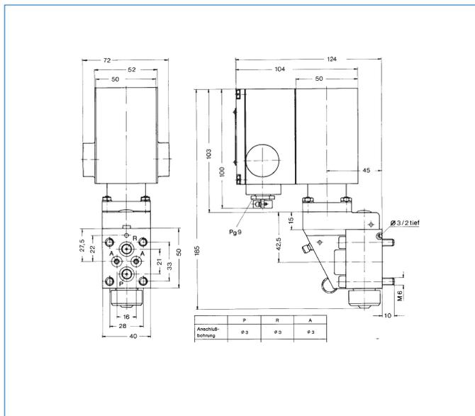
Bei 2/2 Wegeventilen entfallen die mit "A" bezeichneten Bohrungen.
